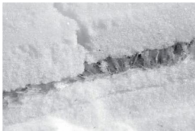
Figura 1: A dalt, fotografia del col·lapse d'una capa de gebre de superfície, presa al indret d'un whumpf. La fractura vertical s'estén fins a la superfície i indica l'àrea afectada (van Herwijnen 2005).
