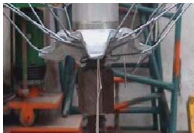
Fig 9: Assaig a punçament de la malla Tecco Mesh G-65 utilitzada opcionalment en els nous models GL i TG.
