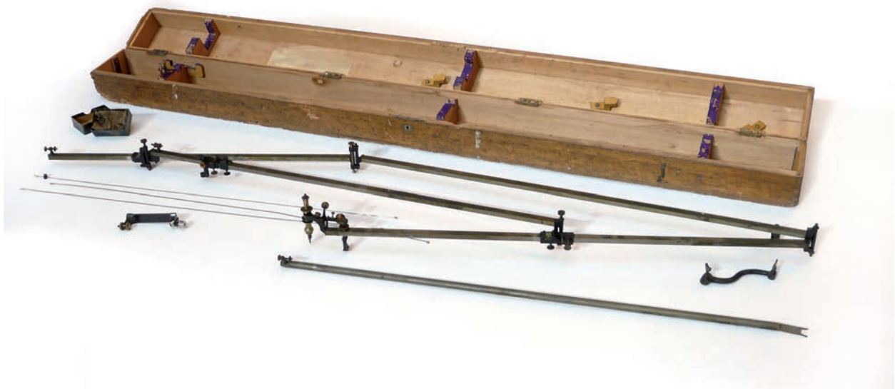
Planímetre Coradi original del Servei Geogràfic de Catalunya utilitzat per a redibuixar mapes amb canvi d'escala.
