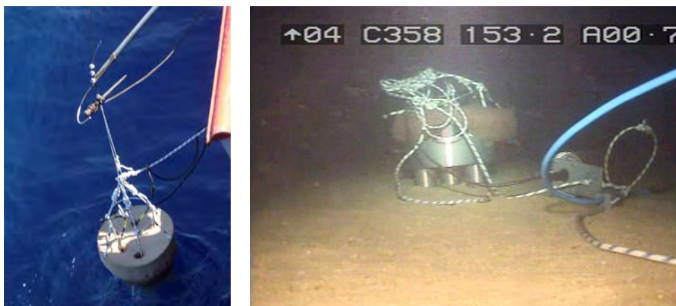
Figura 3: Izquierda: Inmersión del OBS. Derecha: Imagen tomada por el robot submarino del OBS y el DPG depositados sobre el lecho marino.
