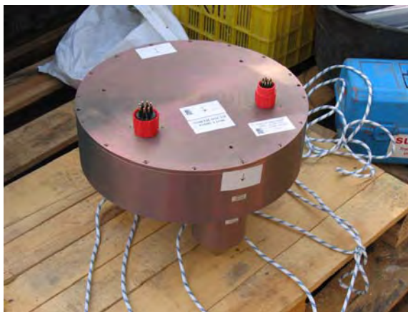
Figura 2: OBS antes de su instalación
