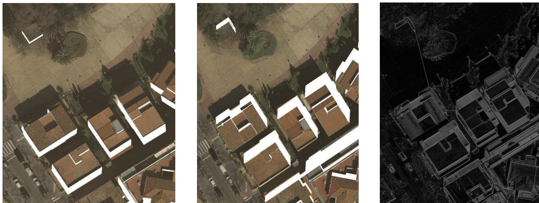
Figura 5: Ocultaciones a resolver (izquierda), fotograma que las cubre (centro) e imagen de diferencias radiométricas y grafo de ocultaciones y segmentos (derecha).
