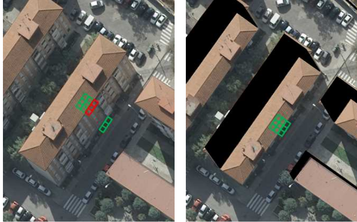
Figura 3: Zonas de singularidad en el fotograma original (izquierda) y en la ortoimagen (derecha)
