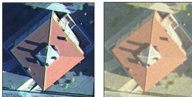
Comparació de dues imatges, una de digital (esquerra) i una altra d'analògica (dreta), amb la mateixa mida de píxels i capturades en el mateix moment.
