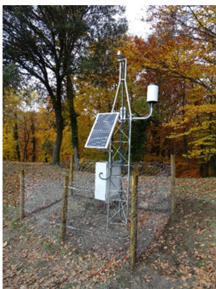
Fig. 1 – Vista de una de las estaciones de la red de medida de parámetros físicos del suelo.
