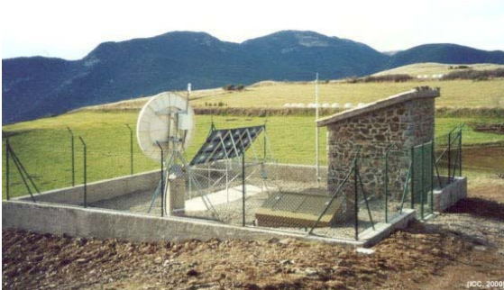
Figura 2 – Estación sísmica de campo de la red VSAT (Seismic station of VSAT network)
