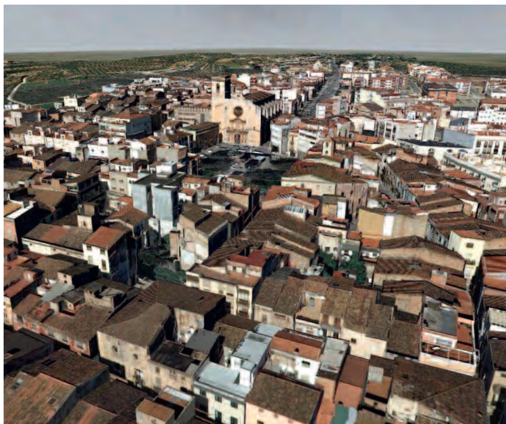
Vilafranca del Penedès, model de ciutat de LOD2 obtingut a partir de cartografia topogràfica 1:1 000 v2.2 i ortofoto estricta, i enriquit amb treball manual.
