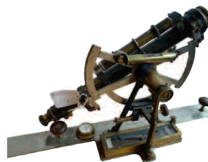
Teodolit azimuthal de final del segle XIX, que forma part de la col·lecció d'aparells cartogràfics antics (Museu 197).
