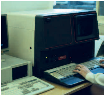
Fotocomponedora Linotype CRTronic 200 (1983-1990).
