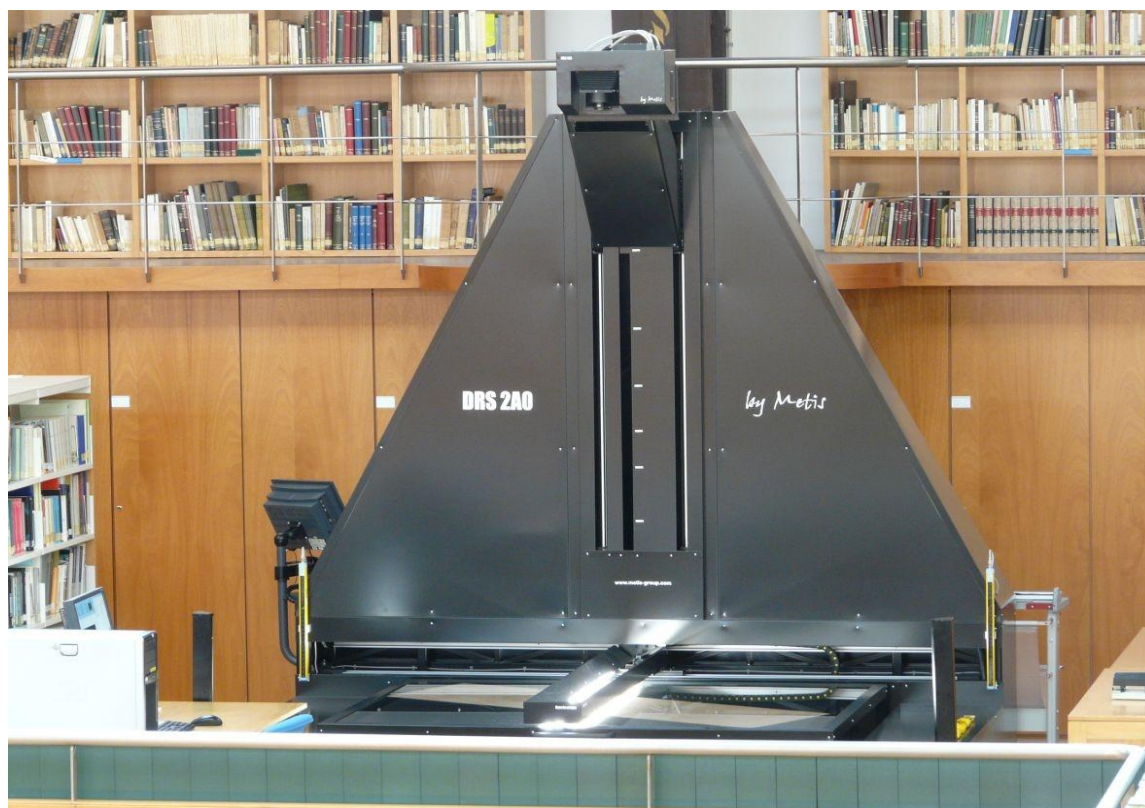
Figura 1: Equipo de digitalización Metis DRS2A0 del ICC, con capacidad para digitalizar originales de hasta 120x180 cm a 300 ppi.
