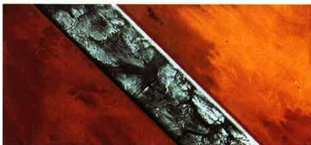
Comparación entre una imagen LANDSAT óptica y la imagen SAR correspondiente, sobre una zona del desierto de Sudán. Obsérvese cómo en la imagen SAR se ven los cauces fluviales enterrados en la arena.
