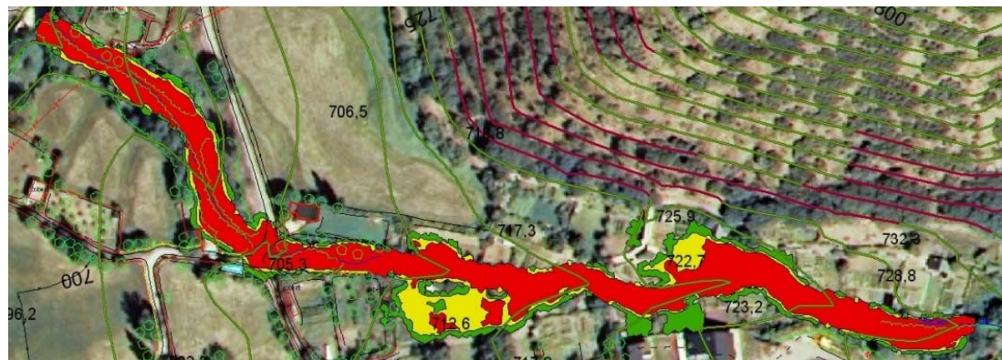
Perillositat baixa, moderada i alta per al període de retorn de 100 anys
