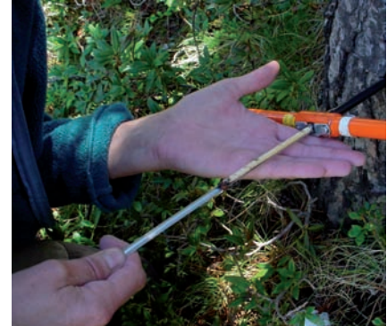
Extracció d'una mostra amb barrina Pressler
