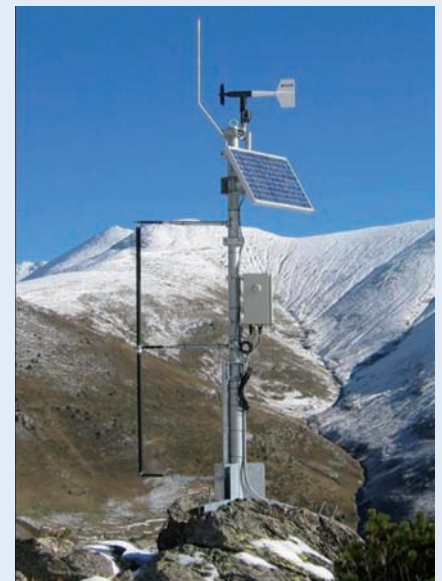
Sensor flowcapt per mesurar el transport de neu pel vent
