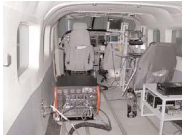
Altímetre làser ALS50-II a l'interior del Cessna Caravan 208B.
