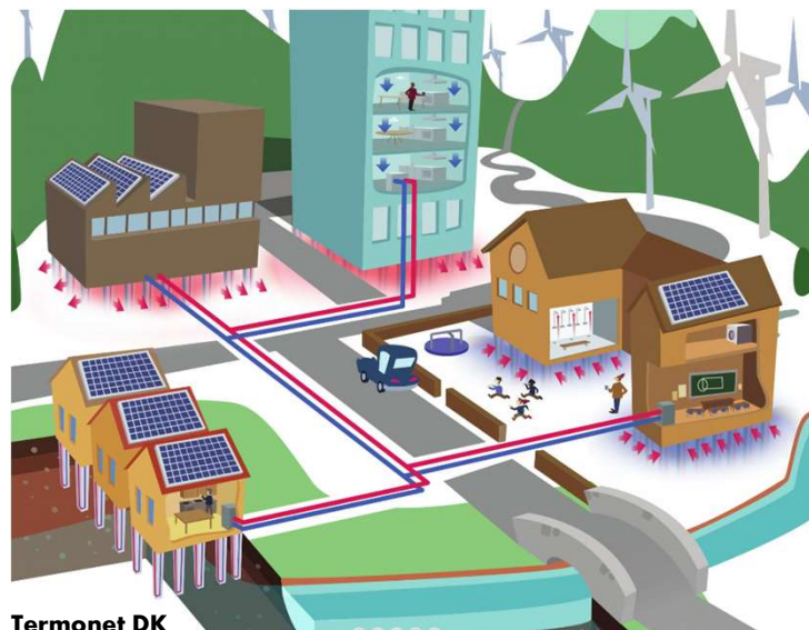
Termonet DK Figura 3. Concepte de xarxes 5GDHC (Termonet, DK).
