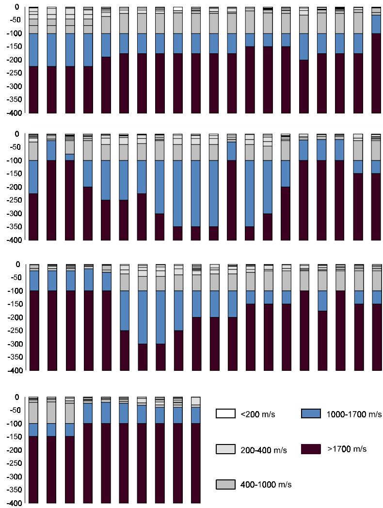
Figura 9. Velocitats de cisalla per a 70 columnes representatives de la ciutat (segons Cid, 1998)
