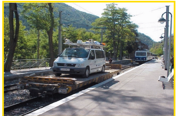
Imatge del sistema GEOMOBIL preparat per a realitzar mesures en una línia fèrria.
