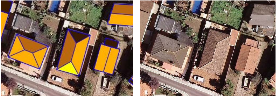
Figura 7. Esquerra: Idoneïtat fotovoltaica segons element de teulada. Dreta: ortoimatge 25cm on es poden interpretar cadascun dels segments que formen la coberta dels edificis residencials
